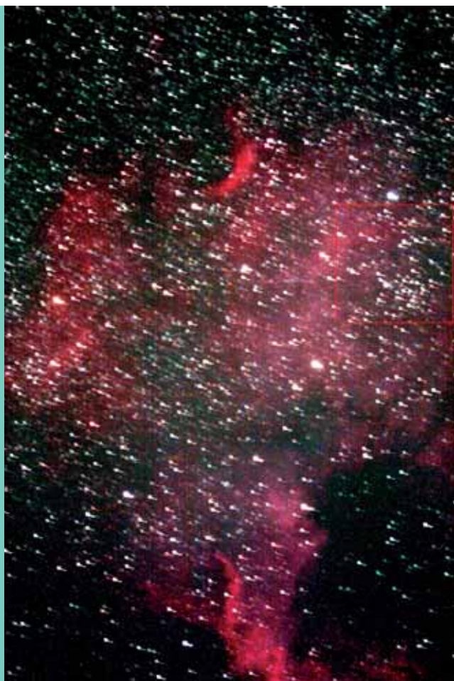
► Lunghe sessioni osservative senza l'uso dell'autoguida possono mettere in evidenza i difetti di inseguimento. Questa è la somma di 60 immagini con posa da 1 minuto riprese nell'arco di 90 minuti nella zona della nebulosa Nord America, nel Cigno.
